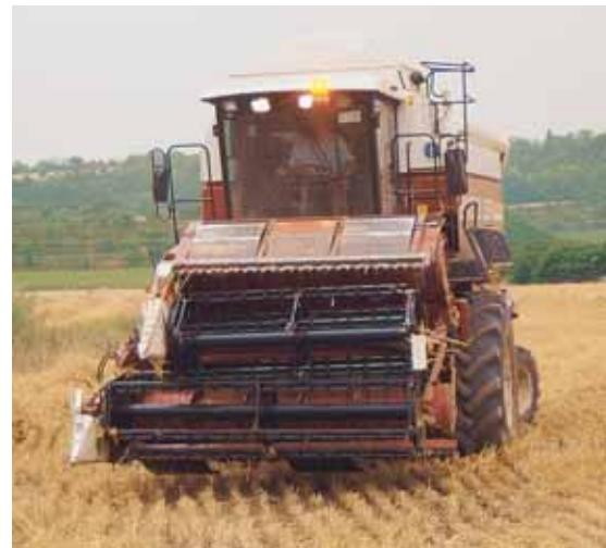
anchura de trabajo con doble sierra al centro, sinfin de alimentacion de grandes dimensiones con dedos retractiles en toda su longitud, distancia minima entre sinfin y canal transportador y posibilidad de cambiar la inclinacion del corte. El conductor efectua las operaciones de cierre y de apertura del corte directamente desde su puesto de conducción por medio de una central electronica.
